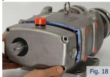
Pour démonter les engrenages (14, 14-1) et le contre-écrou de l'arbre flottant et de l'arbre d'entraînement, il faut d'abord redresser la languette de la rondelle frein avant de desserrer l'écrou de serrage.
