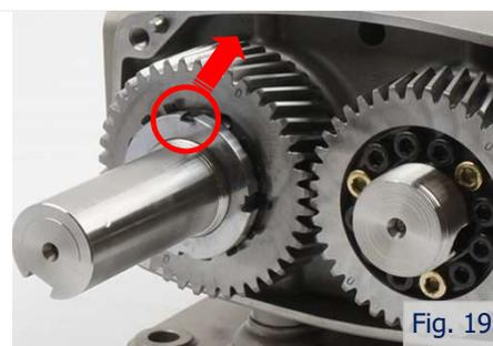
Desserrer les boulons à six pans creux du manchon pour l'enlever et retirer la roue dentée de l'arbre d'entraînement.
