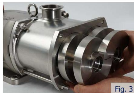
Retirez les joints d'étanchéité statiques de la garniture mécanique du corps de pompe.
