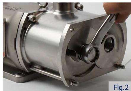
Retirez les rotors des arbres et manipulez les rotors avec soin pour éviter tout dommage. S'ils sont bloqués, ils peuvent être démontés avec un outil d'extraction.
