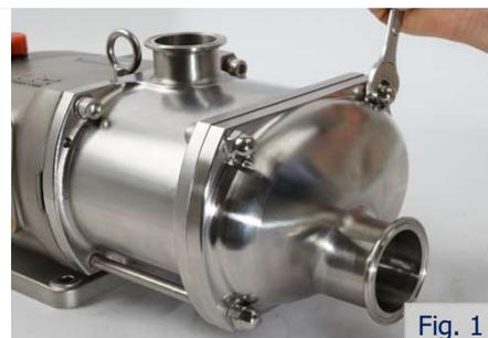
Retirez les boulons à vis et les bagues-ressort.
