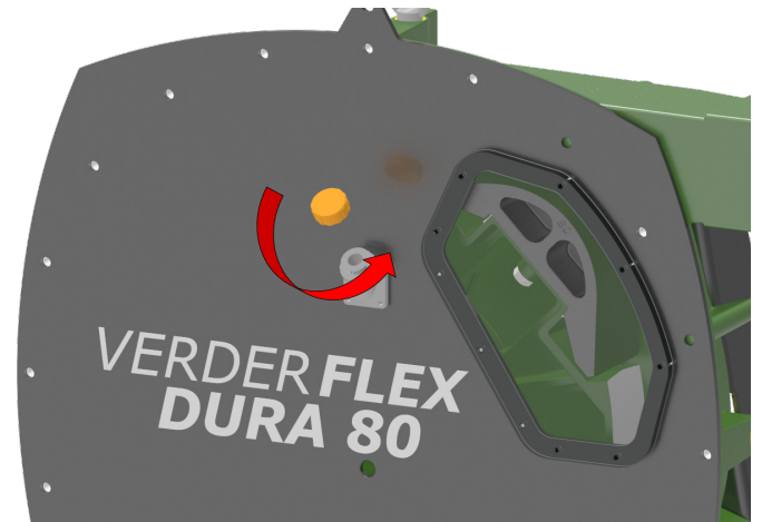
Figura 18. - Llenado de la bomba con lubricante
