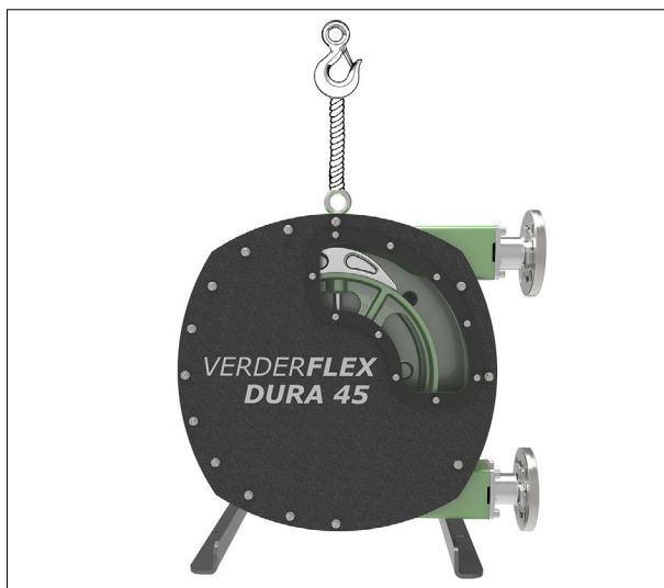
Abbildung 1 Befestigen der Hebeausrüstung an der Pumpe
